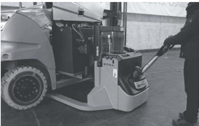
Schneller Batteriewechsel mit dem Hochhubwagen ECU 30
