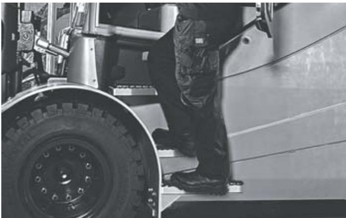
Sicherer Auf- und Abstieg durch von oben sichtbare, griffige Trittstufen
