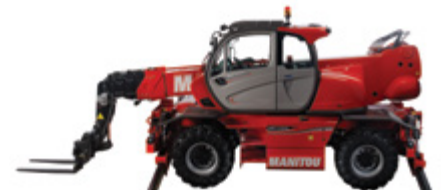
Rotierend bei ausgefahrenen Stützen mit Kranausleger 1.500 kg EN 1459
