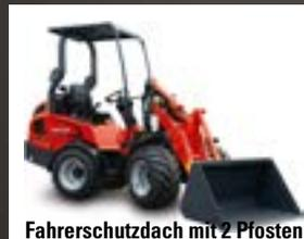
Fahrerschutzdach mit 2 Pfosten
