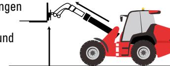
**Bucket shaker:** Ermöglicht schnelles Entleeren der Schaufel, ohne sich wiederholende Bewegungen ausführen zu müssen. Der Mist bleibt nicht mehr am Boden der Schaufel hängen.
