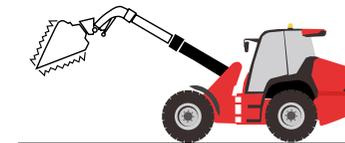
**Return to load:** Anbaugerät und Ausleger können auf einfache Weise in eine vom Bediener gespeicherte Position zurückgeführt werden. Dies ist insbesondere bei Ladevorgängen interessant.
