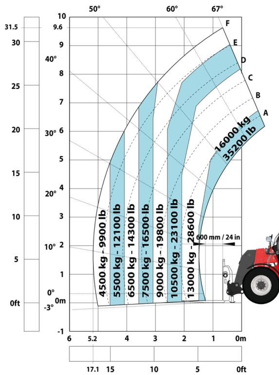
Maschine auf Rädern mit Gabelzinken LC 1200 mm
