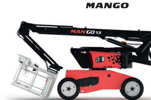
Transportabmessungen (LxBxH) : 4,5 x 1,8 x 2,495 m
