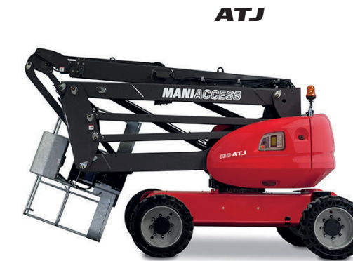
Transportabmessungen ab (LxBxH) : 4,44 x 2,3 x 2,61 m
