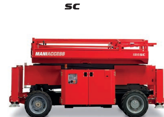
Transportabmessungen (LxBxH) : 3,76 x 1,75 x 2,59 m
